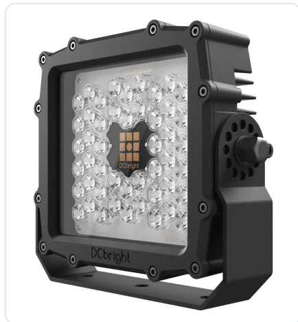
Standardhalterung. Hochfestes 316L, dreht über 360 Grad in Schritten von 30. Treiber extern, in einer Treiberbox an anderer Stelle
