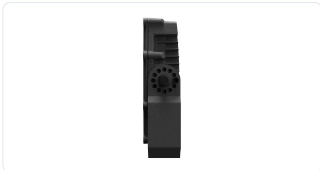
Das Gelenk an der Seite des Arms: der Gelenkbolzen in der Mitte des Zwölflochrings und die Rastschraube in einer der Bohrungen. Beide Seiten sind gleich
