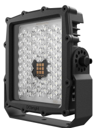
Shark AC. 90 bis 305 oder 180 bis 528 VAC mit einem externen Treiber BLD320 oder TLD320, ohne Box oder in einer Treiberbox. SHAC01
