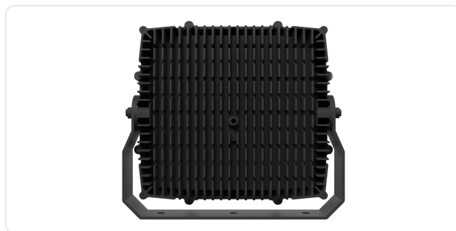
Las aletas de refrigeración en la parte trasera, con el prensaestopas en el centro. Esto es lo que debe permanecer libre
