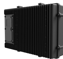
Caja del driver DRB-2. Admite sistemas de hasta 2.000 W y es la caja en la que encaja el TLD800. 441 × 290 × 145 mm, 10,4 kg, IP66 e IP67
