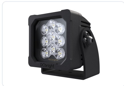
Piranha 9. Nueve LED, 70 W, 8.400 lúmenes. En AC con un driver BLD075 remoto, PIAC01, o en 24 V DC con los drivers a bordo, PIDC02
