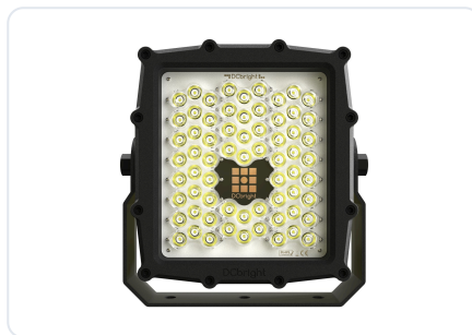
Shark DC 48 V. 35 à 60 VDC, drivers sur la carte, pour les grandes grues électriques sur une alimentation 48 V, sans onduleur dans la chaîne. SHDC02
