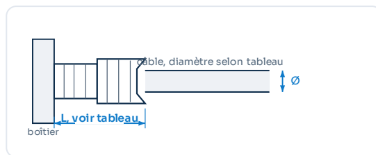
Où se mesure la dimension L
