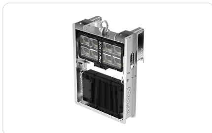
Cadre de grue à tour. Le One de 600 W replié dans le cadre DL-CCB-600 avec son boîtier driver, suspendu à la poutre de la grue, section 6.3
