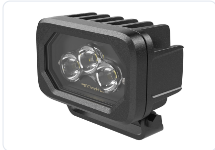
Goby Mini. Le même produit dans un boîtier de 112 sur 70 mm, 2 300 lm, 1,1 kg. GODC01
