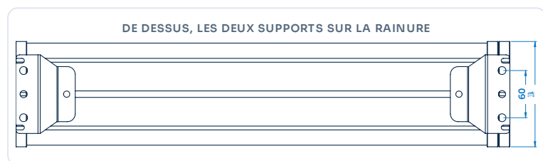
Vue de dessus. Les deux supports se logent dans la rainure supérieure et peuvent être placés n'importe où sur la longueur ; le dessin les montre aux extrémités
