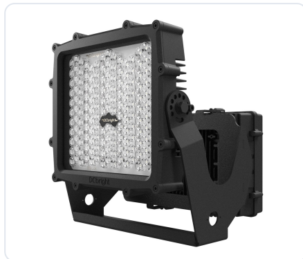
Support de fixation arrière. AC uniquement. À plat contre une structure, le driver porté sur le support derrière le luminaire. Encombrement 484 × 530 × 427 mm
