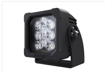
Piranha 9. Neuf LED, 70 W, 8 400 lumens. En AC avec un driver BLD075 déporté, PIAC01, ou en 24 V DC avec les drivers sur la platine, PIDC02
