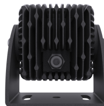
L'arrière du Piranha : les ailettes de refroidissement, l'entrée de câble au centre et le pied du support avec son trou central et ses deux trous oblongs
