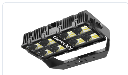
One. Eén module, 320, 400 of 600 W. De driver zit bij 320 en 400 W in de armatuur en is bij 600 W extern. DARK01 tot DARK03
