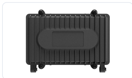
DRB-1. Eén driver tot 320 W in een aluminium kast met koelribben, IP66 en IP67, 4,2 kg. Montage op wand, mast of achterzijde. De standaardkast voor één floodlight
