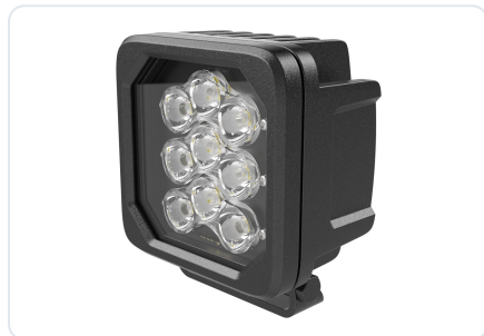
Goby. Vier lichtniveaus in één behuizing van 120 bij 120 mm, 4.600 tot 8.200 lm, 1,8 kg. GODC07, GODC06, GODC05 en GODC03
