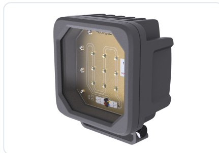
Hoge temperatuur. Geschikt tot plus 120 graden Celsius, 2.600 lm bij 13 W, glasfront, siliconenkabel. GOHT01 en GOHT02
