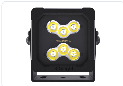
Piranha 6. Zes LED's, 55 W, 6.300 lumen, 9 tot 35 VDC voor machines van 12 en 24 V, drivers aan boord. Alleen DC, PIDC01
