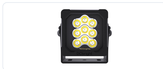
Piranha 9 met de spot van 14 graden. Negen lenzen, één per LED, achter één polycarbonaat of glazen front
