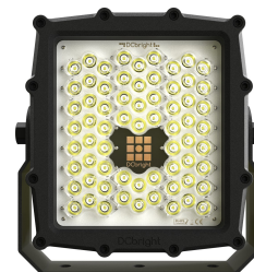
Shark DC 48 V. 35 tot 60 VDC, drivers op de printplaat, voor grote elektrische kranen op een voeding van 48 V, zonder omvormer in de keten. SHDC02
