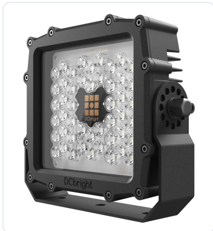
Standaardbeugel. Hoogvast 316L, draait 360 graden rond in stappen van 30. Driver extern, in een driverbox elders
