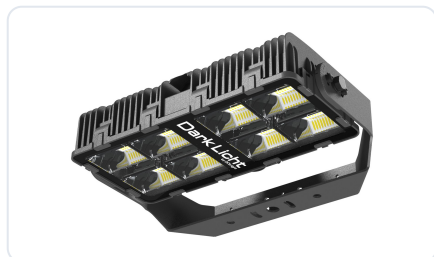
One. Un módulo, 320, 400 o 600 W. El driver va dentro de la luminaria con 320 y 400 W y es externo con 600 W. DARK01 a DARK03
