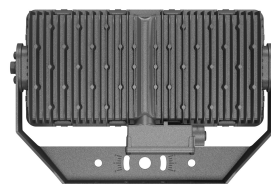
La parte trasera del One: las aletas de refrigeración del módulo, la caja de conexiones en el centro y la placa de características
