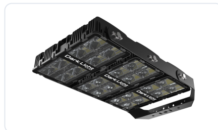
Three. Tres módulos, 1.800 W, tres drivers TLD600 externos. La luminaria full cut-off más grande de la gama. DARK06
