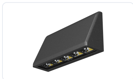
Wallpack 100. 16 000 lm à 100 W, réglable à partir de 10 W. DRKW01
