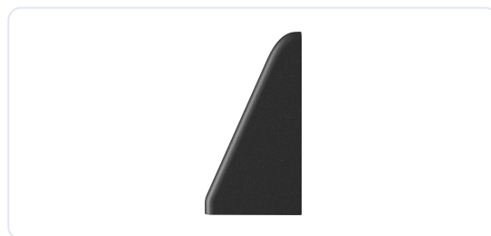
De WP aan de wand. Het glas is de hellende onderzijde; de bovenzijde is dicht en de gevel erboven blijft donker
