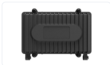
DRB-1. Ein Treiber bis 320 W in einer Aluminiumbox mit Kühlrippen, IP66 und IP67, 4,2 kg. Wand-, Mast- oder Rückseitenmontage. Die Standardbox für einen Flutlichtstrahler
