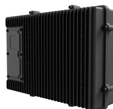
Der DRB-2 mit dem Deckel des Klemmenraums auf der Abdeckung. Vor Ort wird nur dieser Deckel abgenommen; der Treiberraum bleibt geschlossen, bis ein Treiber ersetzt wird
