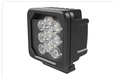
Goby. Vier Leistungsstufen in einem Gehäuse von 120 × 120 mm, 4.600 bis 8.200 lm, 1,8 kg. GODC07, GODC06, GODC05 und GODC03
