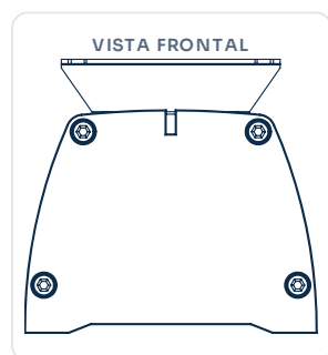
La sección transversal, ampliada: 134 mm sobre el soporte, 102 mm de carcasa, 125 mm sobre la placa base
