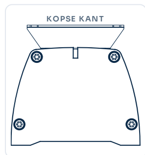
De doorsnede, vergroot: 134 mm over de beugel, 102 mm behuizing, 125 mm over de grondplaat
