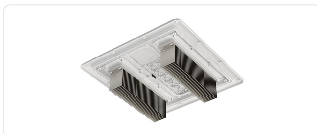
Het koellichaam van het inbouwpaneel, boven het plafond. Dit moet vrij blijven, en het is ook het koellichaam van de driver
