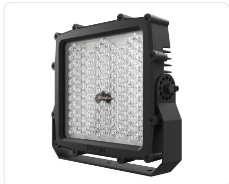
Standardhalterung. Hochfestes 316L, zwölf Positionen in Schritten von 30 Grad. Treiber extern, in einer Treiberbox an anderer Stelle
