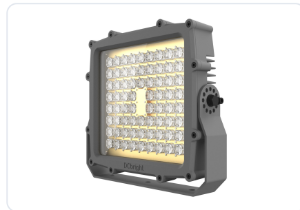
Hochttemperatur. Ausgelegt bis plus 120 Grad Celsius, 65.000 lm bei 320 W, Glasfront. ORHT01 und ORHT02
