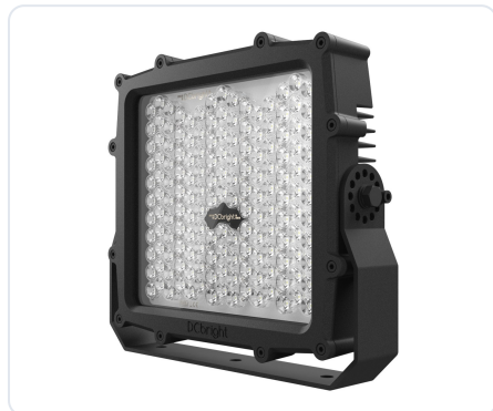
Standaardbeugel. Hoogvast 316L, twaalf posities in stappen van 30 graden. Driver extern, in een driverbox elders
