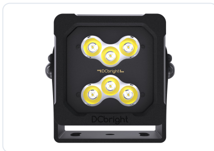
Piranha 6. Sechs LEDs, 55 W, 6.300 Lumen, 9 bis 35 VDC für Maschinen mit 12 und 24 V, Treiber auf der Platine. Nur DC, PIDC01
