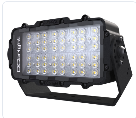
Standardhalterung. Hochfestes 316L, dreht über 360 Grad in Schritten von 30. Treiber extern, in einer Treiberbox an anderer Stelle
