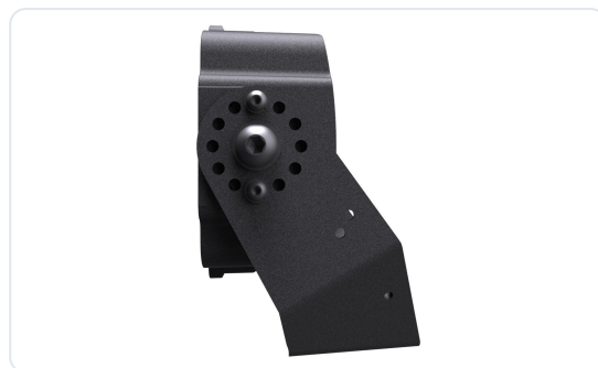
Le disque d'indexation : douze trous, un boulon de pivot central et deux vis d'indexation. Douze trous, d'où les 30 degrés
